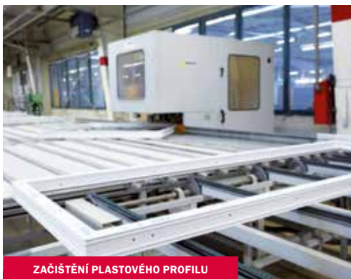
VÝROBNÍ LINKA NA PLASTOVÁ OKNA
